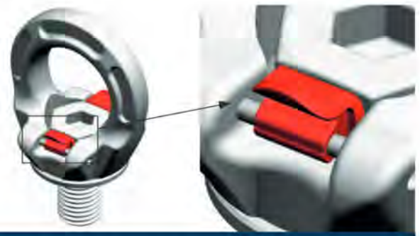
Bild 3: Stellung ‚A‘ – Beide Sperren berühren die Schraube. Nur bei Montage und Demontage zulässig
