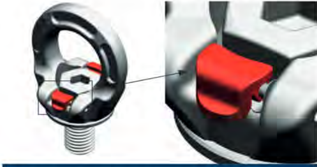
Bild 4: Stellung ‚B‘ – keine Berührung der Sperren mit der Schraube Nur in dieser Stellung ist der Anschlagpunkt einsatzbereit
