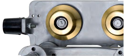
Ab der Ausführung **Medium** sind sie aus Bronze. Bei **Basic** sind die Laufrollen MKS (Mikro Korrosionsschutz System) beschichtet. Zudem sind alle Fahrwerke mit Puffern ausgerüstet, um beim Anschlagen gegen die Endpunkte mechanisch erzeugte Funken zu vermeiden.
