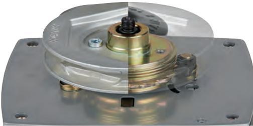
Zur Absenkung der Temperatur (heiße Oberfläche) wird zusätzlich bei der Baureihe Yalelift 360 eine Kühlnabe eingesetzt. Dadurch wird die entstehende Temperatur besser abgeleitet.
