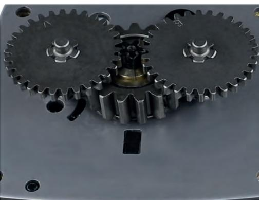
Bei allen manuellen Hebezeugen ist das Getriebe ausreichend gefettet. Bei dem Modell OMEGA Atex und allen Druckluftkettenzügen läuft das Getriebe in Öl, somit kommt hier noch die Flüssigkeitskapselung "k" hinzu. Durch die Schmierung (Fett oder Öl) wird eine Funkenbildung im Getriebe vermieden.
