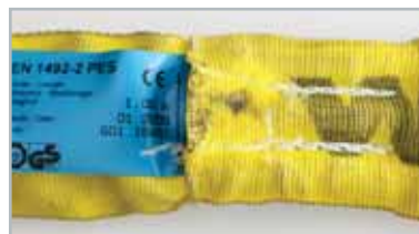
Nahtbrüche der Ummantelung
