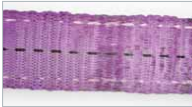
Starke Verformung oder Verschmelzen von Garnen durch Hitze (glänzende Oberfläche und/oder Verhärtung des Bandes).
