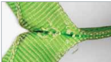
Beschädigung von tragenden Nähten.
