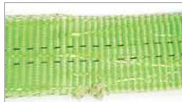
Jegliche Beschädigung der Webkante
