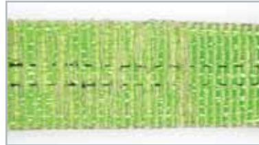
Beschädigungen des Gewebes durch Abrieb oder Schnitte
