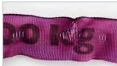
Glänzende Oberfläche und/oder Verhärtung des Gewebes durch Hitze
