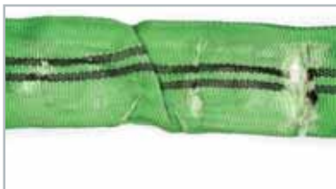
Beschädigung der Hülle durch Abrieb oder Schnitte - bei sichtbarem Kern muss die Rundschlinge sofort außer Betrieb genommen werden!
