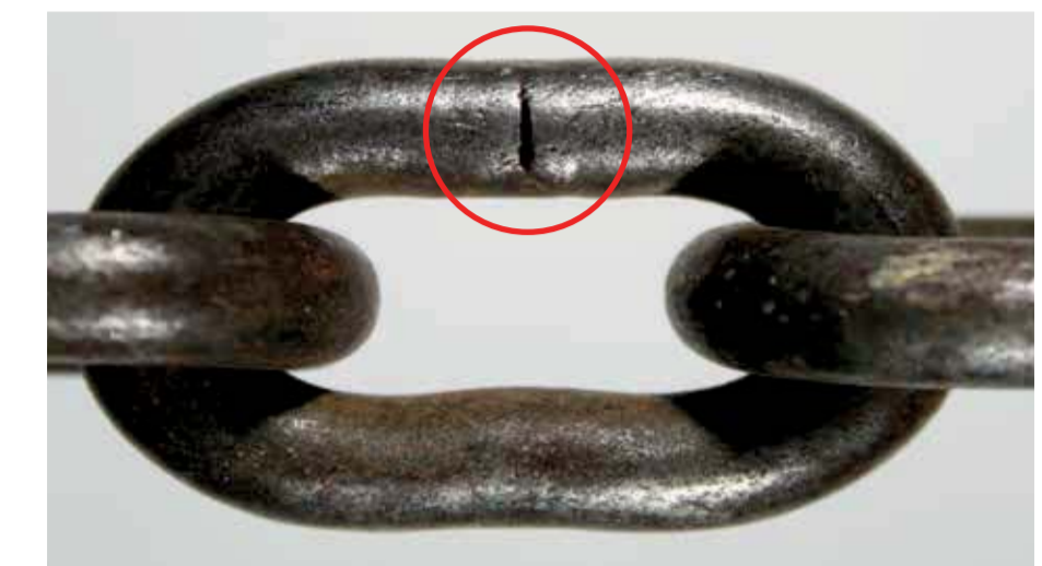
deutlich sichtbare Risse
