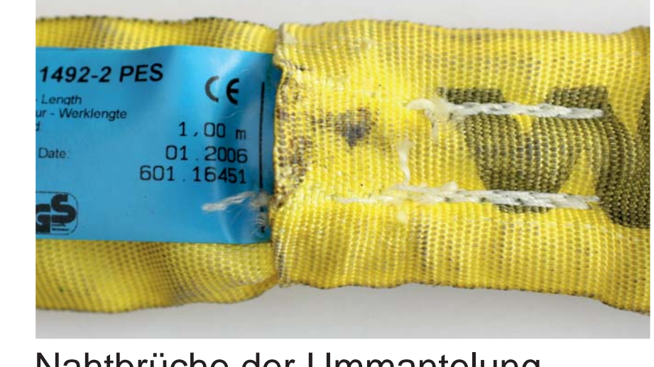
Nahtbrüche der Ummantelung
