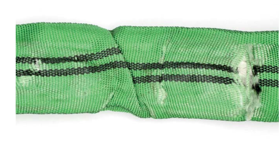
Beschädigung der Hülle durch Abrieb oder Schnitte - bei sichtbarem Kern muss die Rundschlinge sofort außer Betrieb genommen werden!
