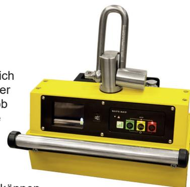
**Der Automatikmodus ermöglicht einen berührungslosen Schaltvorgang.** Bei jedem Aufsetzen des Magneten und Entlasten der Kranöse wird ein Schaltvorgang erzeugt und der Magnet schaltet ein oder aus. Zusammen mit der optional erhältlichen Positionierdeichsel können Werkstücke punktgenau aufgenommen, geführt und abgesetzt werden.
