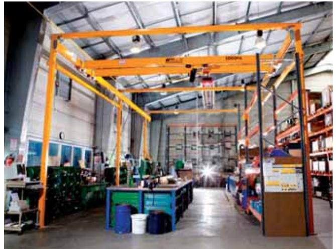
Das PROSYSTEM Kleinkransystem basiert auf drei optimierten Stahlprofilen. Die Profile 125, 200, und 260 decken einen Lastbereich bis zu 2000 kg ab.
