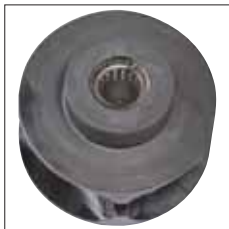
Nadellager im Lastkettenrad
