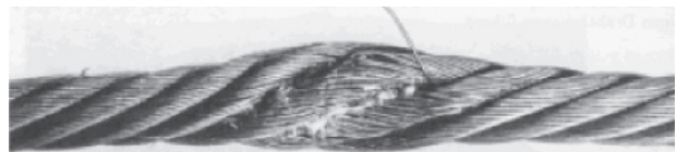
Bild 4: Drahtseil mit Abplattung, entstanden durch Überfahren
