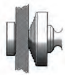
Abb. 1 Durch Anziehen der Spindel mit normaler Handkraft wird die Gegenocke sicher am zu hebenden Gut angedrückt.
