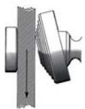
Abb. 3 FALSCH! Die Klemmkraft wird durch zu festes Anziehen der Spindel keineswegs erhöht! Denn die Gegenocke kann sich dadurch nicht mehr optimal an die Last anpassen. Das führt zu einer vorzeitigen Alterung der Verzahnung und des Gelenks.
