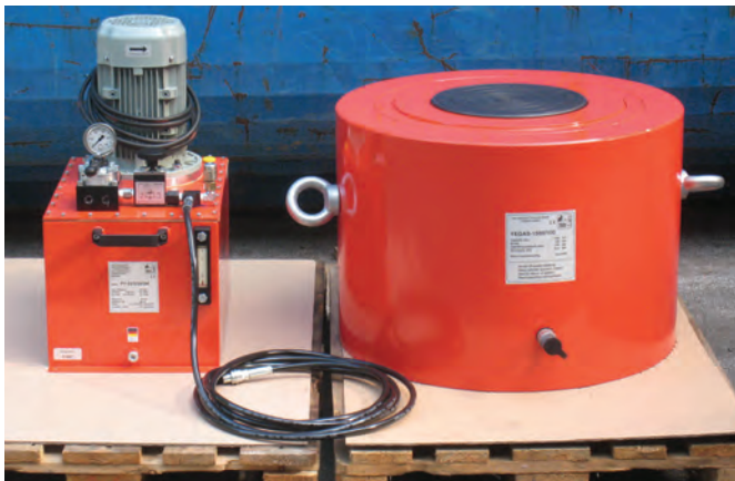
Yale Hydraulikzylinder mit einer Druckkraft von 1550 t
