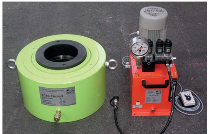
Spezieller Hohlkolbenzylinder und Hydraulikaggregat zur Betätigung einer speziellen Auslösevorrichtung bei Fallversuchen. Behälter mit einem Gewicht von 100 Tonnen müssen bei Fallversuchen in ca. 20 m Höhe ausgeklinkt werden.
