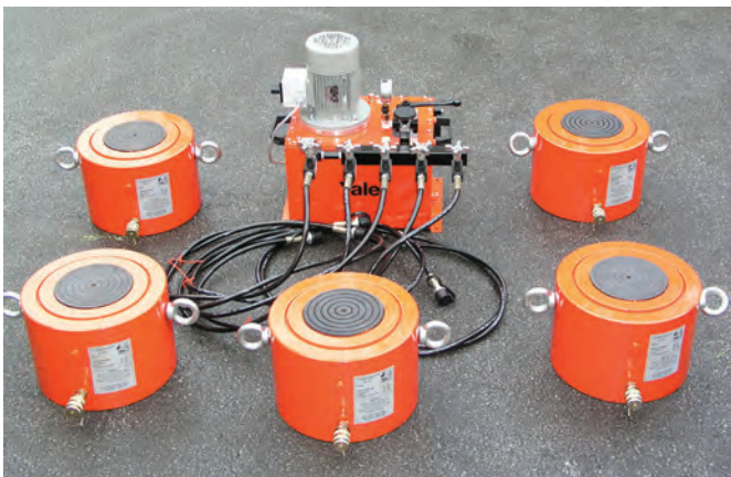
System zum Anheben des Aufbaus eines Schaufelradbaggers zum Auswechseln des Lagers des Drehkranses mit einem Gesamtgewicht von ca. 800 t. Die besonders niedrig bauenden Hydraulikzylinder können zusammen oder einzeln mit Druck beaufschlagt werden.
