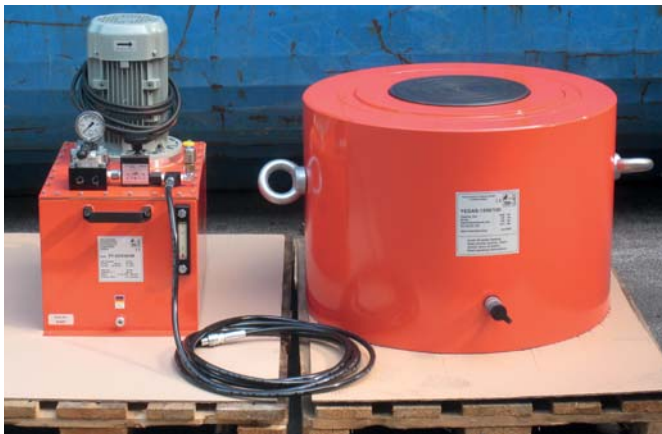
Yale Hydraulikzylinder mit einer Druckkraft von 1550 t
