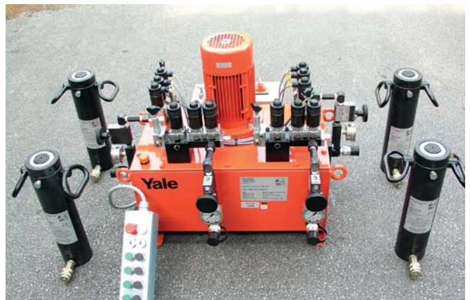
Hydrauliksystem zu Hebung von Brücken und vergleichbaren Konstruktionen. Die 4-Strom Bauweise ermöglicht ein synchrones Heben von Lasten, auch wenn diese ungleich auf die jeweiligen Hydraulikzylinder verteilt sind. Die Ansteuerung (einzeln zum Nivellieren oder gemeinsam) erfolgt über die Drucktasten der Fernbedienung. Die individuellen Auflasten können permanent an den Manometern abgelesen werden. Die Hydraulikzylinder mit Sicherheitsmuttern gewährleisten ein sicheres Abstützen der gehobenen Last in allen Positionen.
