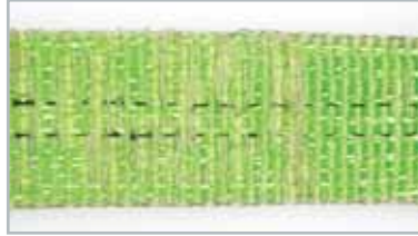
Beschädigungen des Gewebes durch Abrieb oder Schnitte
