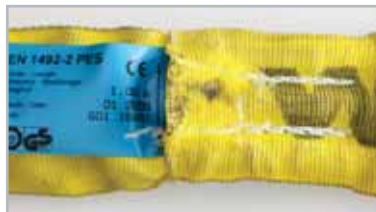
Nahtbrüche der Ummantelung
