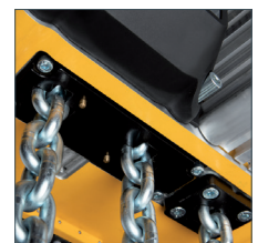
Endlagenschalter Standard: Endlagenschalter werden als im Kettenentflechter eingearbeitete Messingstößel, die auf Mikroschalter einwirken, ausgeführt.
