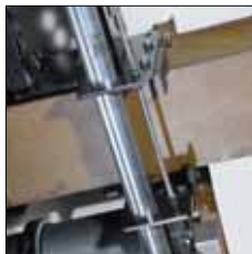
Flanschverstellung einfache Anpassung über eine Gewindespindel
