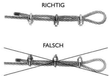
Die Klemmdeckel sind am ziehenden Seil zu montieren.
