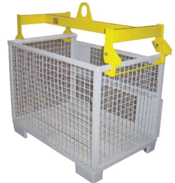
Beim Einsatz der Gitterboxtraverse müssen die Traversenhaken immer am oberen Rahmen der Gitterboxen eingehängt werden.
