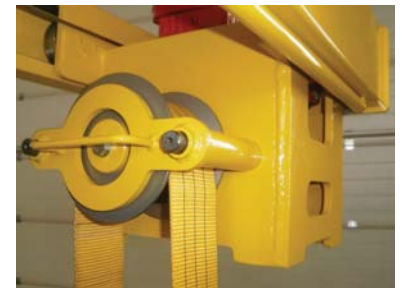
Stufenlos verstellbare Greifweite mit Elektromotor.
