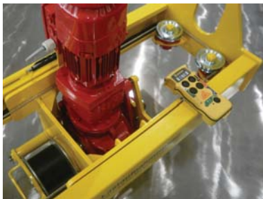
Elektromotorisch angetriebene Gurtrollen.
