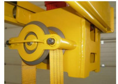
Stufenlos verstellbare Greifweite mit Elektromotor.
