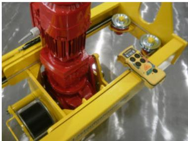
Elektromotorisch angetriebene Gurtrollen.
