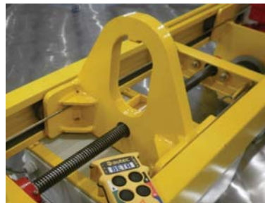
Mittelöse zum Lastausgleich elektronisch fahrbar.
